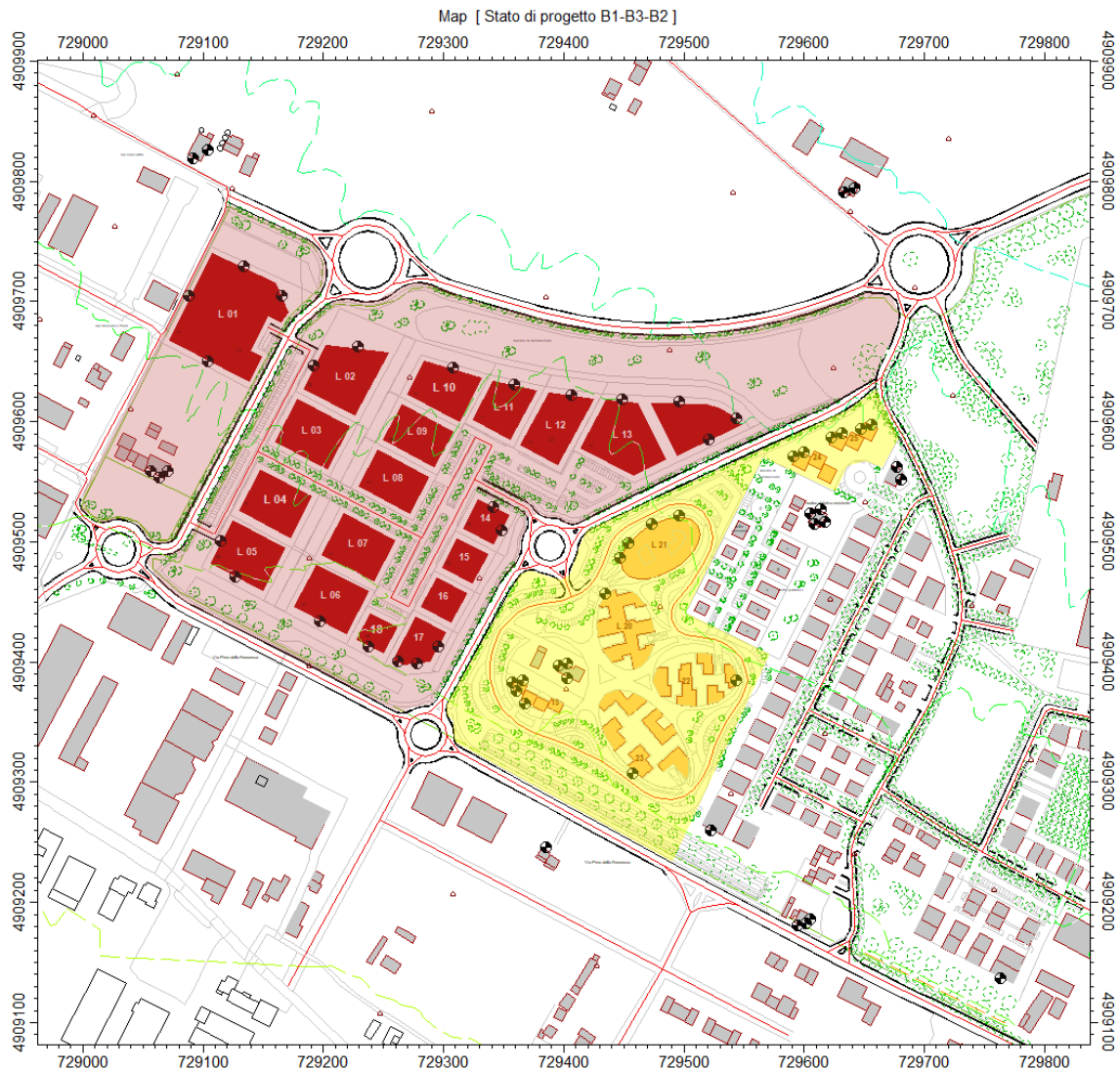
Figura 45: Individuazione dei recettori bersaglio di progetto per la verifica normativa di clima acustico.
